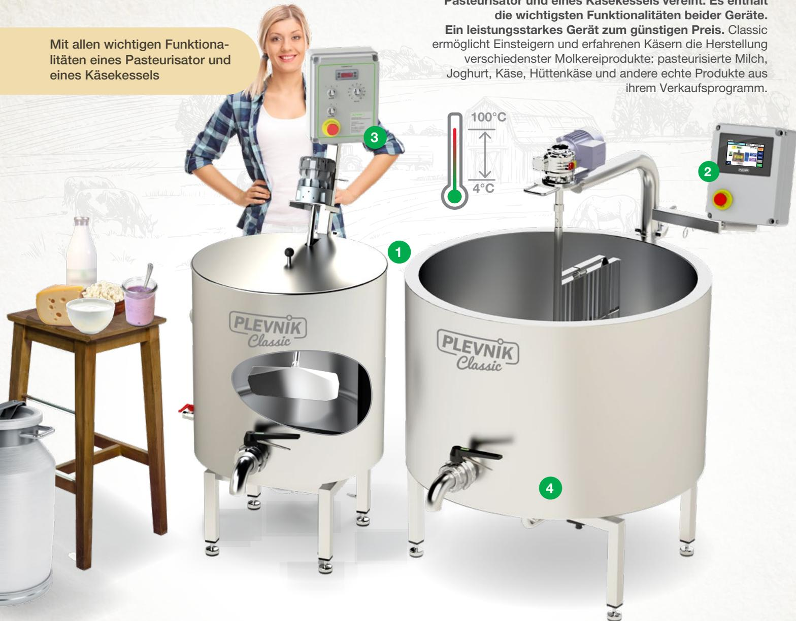
Die 50I- und 125I-Version des Classic verfügen über ein doppelt beschichtetes, isoliertes Gefäß mit Deckel und sind aus AISI 304-Edelstahl gefertigt. Die Heizung und Kühlung erfolgen über den Boden und den Mantel des Gefäßes. Der Kessel wird in einem Wasserbad erhitzt und mit Wasser aus der Leitung oder einem Wassertank gekühlt. Die thermische Behandlung ist bis 92°C möglich. Die Temperatur kann über ein Thermostat am Elektroschaltkasten geregelt werden.
