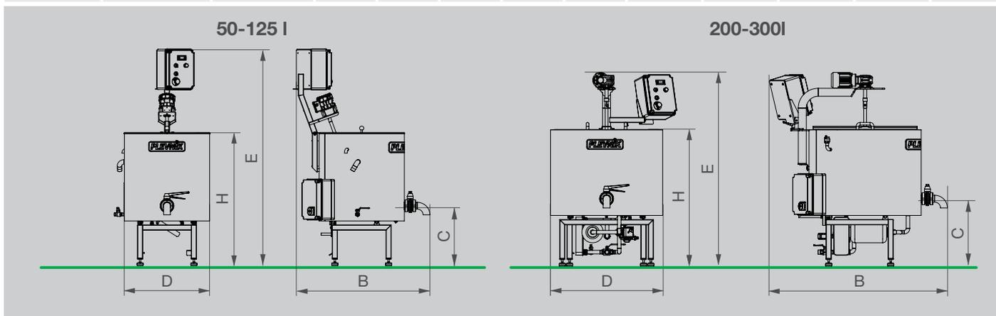
Anschlussleistung 400V 3N 50Hz 4-15 kW. Endgültige Nennleistung des Gerätes (HEIZLEISTUNG + 0,5kW). Eine Anpassung an andere Leistungsparameter (60 Hz etc.) ist auf Anfrage möglich.
