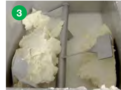
Nach 20 Minuten wird die Buttermilch abgesondert und durch das Ablassventil ausgelassen.
