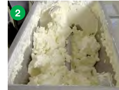
Zustand nach 10 Minuten Hochgeschwindigkeitsmischen.
